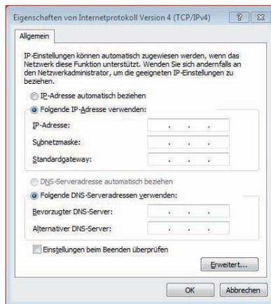
Der Netzanteil der IP-Adresse ist von der Subnetzmaske abhängig. Von der IP-Adresse des EXDUL-581 müssen alle Oktette, die in der Subnetzmaske mit 255 belegt sind, in die IP-Adresse des Rechners übernommen werden (siehe auch Kapitel 4.6 Zusammensetzung und Aufbau der IP-Adresse).
