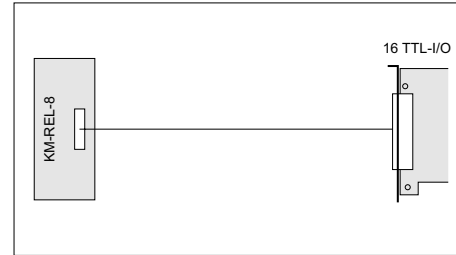
8 isol. Ausgänge 5A
