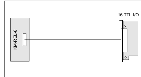
8 isol. Ausgänge 5A
